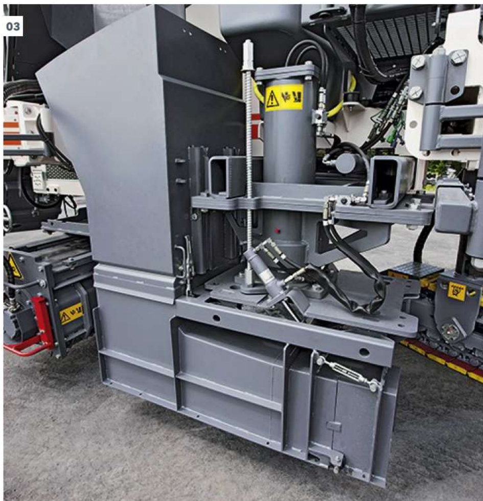
03 O sistema de troca rápida permite alternar, de forma rápida e simples, entre perfil de meio-fio e perfil de calha.
