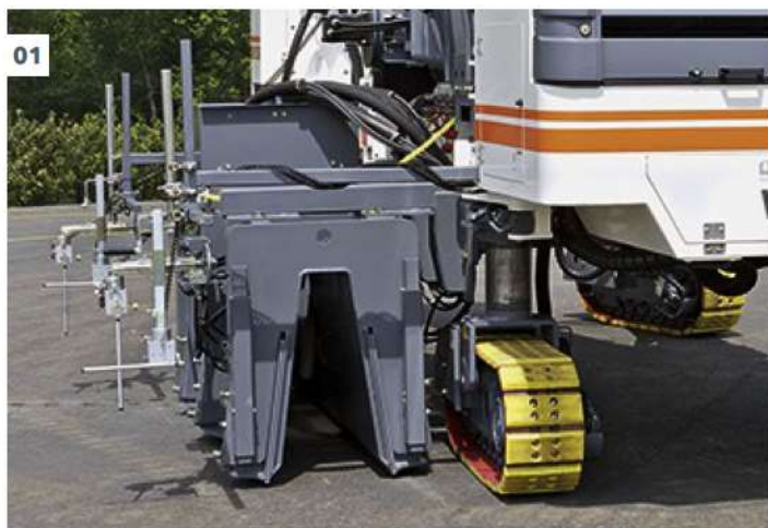
01 - 02 Molde deslizante offset com função telescópica hidráulica.
